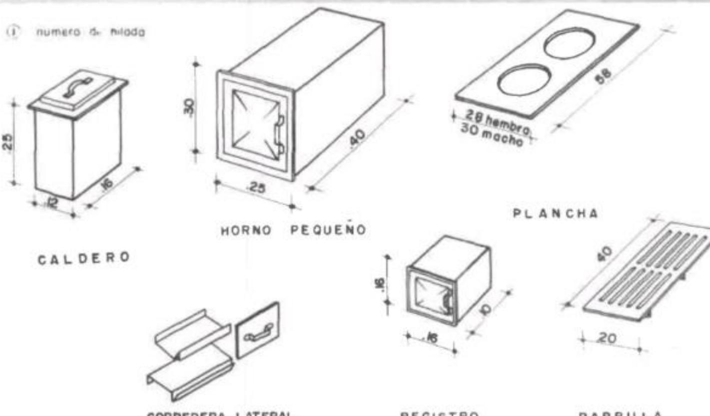
**NOTA:** Es aconsejable utilizar la estufa después de una semana de construida. Una vez prendida la estufa, el tiraje se inicia mediante la utilización de una tea o papel encendido, introducido por el registro ubicado debajo del horno (deshollinador).
